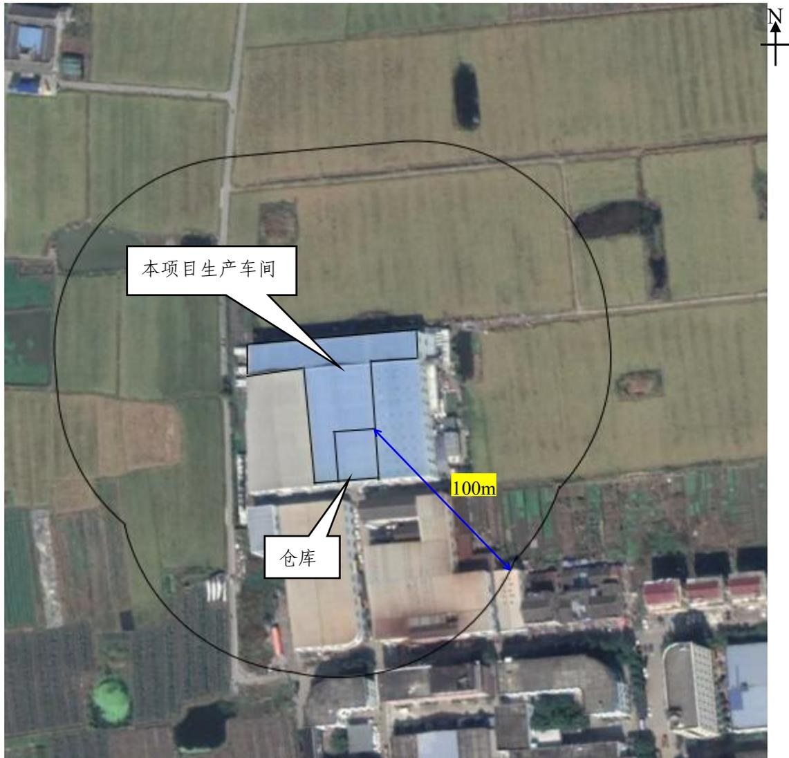
图 7-1 项目生产车间卫生防护距离示意图
